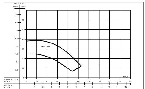
**2900 RPM - 50Hz.**CAPACITIES TO 105 GPM (6.6 LPS)
